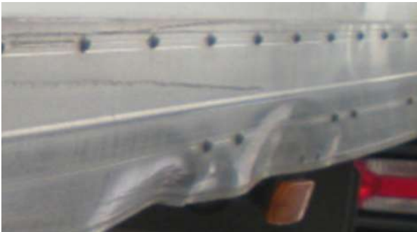
↻ Perfis laterais sob o chassis: deformações onde não seja possível aplicar reparação económica, perfurações, remoção de uma secção do perfil
