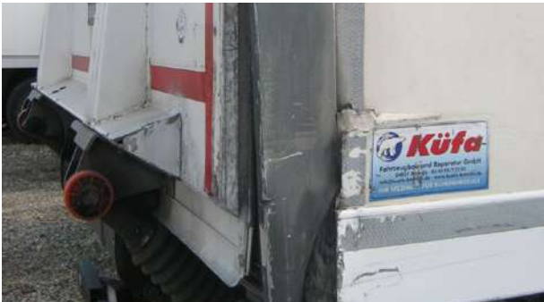
Portas laterais e traseiras: deformação significativa
