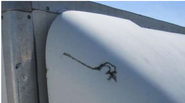
Cabina sobre o motor e defletor: danos possíveis de aplicar reparação económica
