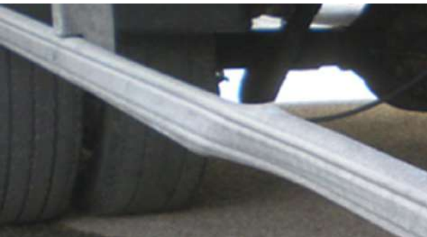
↻ Suportes inferiores: deformação que excedem a reparação económica
