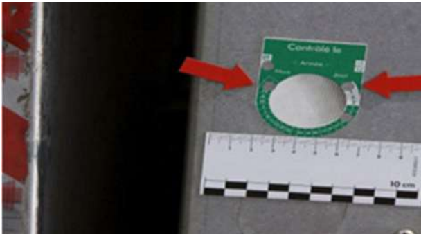
Taipal de carregamento: datas de verificação expiradas
