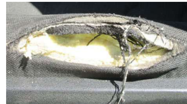
Falta da espuma ou estrutura partida
