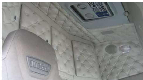
Descoloração ligeira devido aos raios de sol
