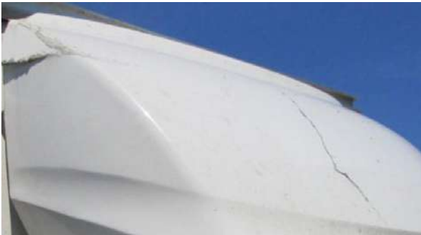
Cabina sobre o motor e defletor: fissura significativa, peça em falta ou que não seja possível efetuar reparação económica
