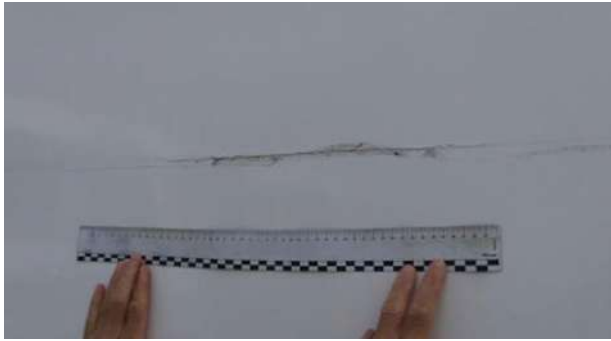
Painéis laterais: risco com remoção de material ≥ 20 cm dentro da reparação económica
