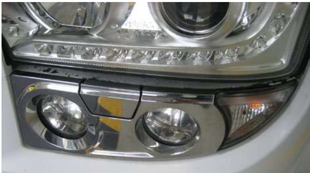
Risco no campo de iluminação, fissura, condensação, partido ou fixação partida
