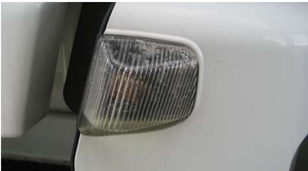
Risco no campo de iluminação, fissura, condensação, partido ou fixação partida
