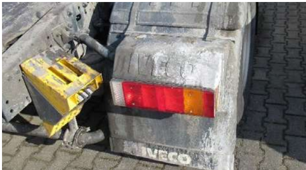
Descoloração profunda devido aos elementos químicos
