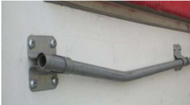
Estofos e hastes: hastes e estofos deformados dentro da reparação económica
