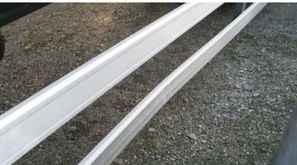
✂ Suportes inferiores: deformação dentro da reparação económica
