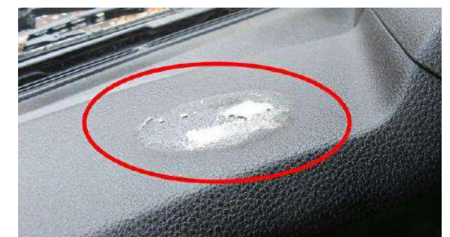
Revestimentos de plástico e de tecido: rasgo, orifício > 5 mm, marcas indeléveis
