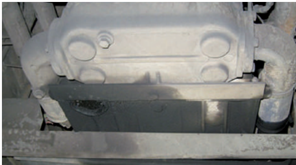
Fugas da caixa da direção e bomba da direção assistida
