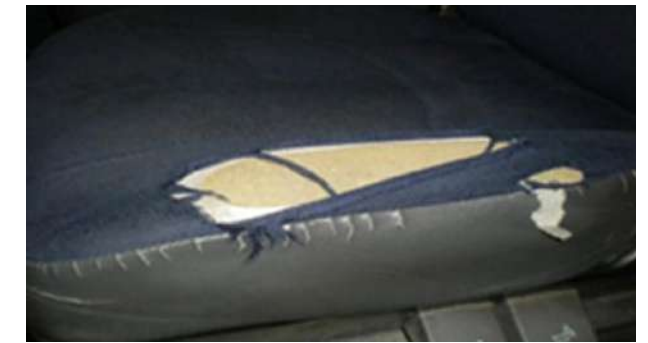
Queimadura > 3 mm, perfuração ou rasgo na tampa, sem deterioração da espuma
